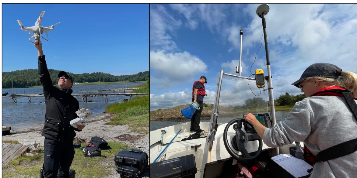
Figur 5. Provtagning av ålgräsens areella utbredning med flygande drönare samt med dropvideo och vattenkikare för att samla in tränings- och valideringsdata för klassificering av ålgräs. På bilden till höger används en RTK-GPS för att få hög precision i provpunkternas position (Foto: Per-Olav Moksnes).
